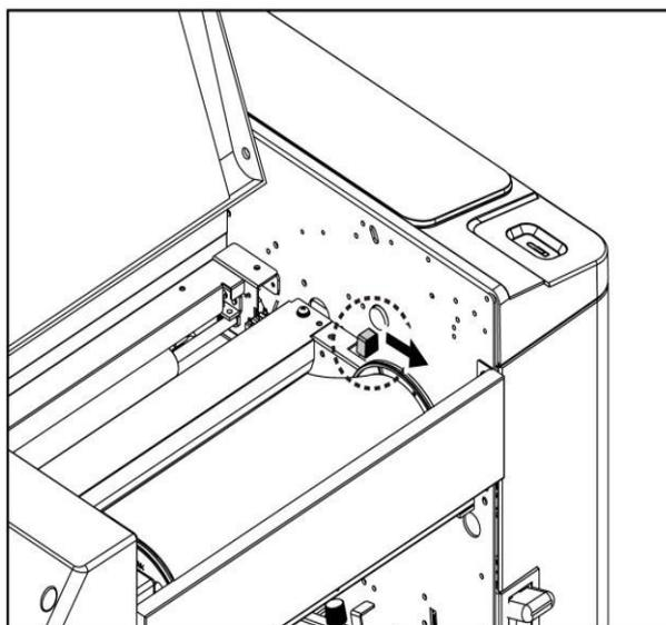
**Второй метод:** Потяните рычаг блокировки термоголовки в положение «Закрыто». Подайте край мастер-пленки между термоголовкой и направляющей мастер-плёнки левой рукой, одновременно нажмите микропереключатель ножа на длительное время, мастер-пленка протянется вперед на 5-10 мм. Правой рукой поверните рычаг термоголовки в положение «Открыто» а левой рукой выровняйте край мастер-плёнки.
