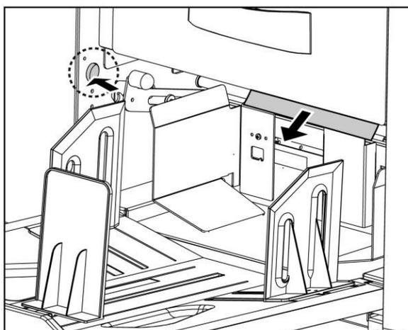
2. Продолжайте удерживать микропереключатель барабана, до тех пор пока барабан перестанет вращаться и Вы не услышите кратковременный звуковой сигнал.
