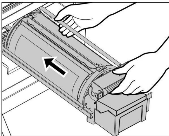
6. Поднимите замок раскатного цилиндра. Вставьте раскатный цилиндр в устройство;
