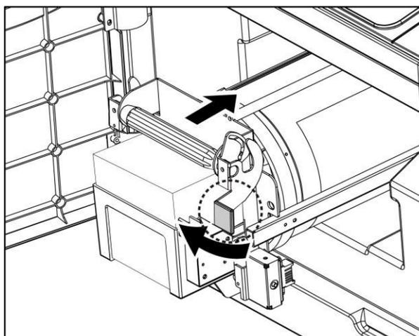
7. Закройте замок раскатного цилиндра;
