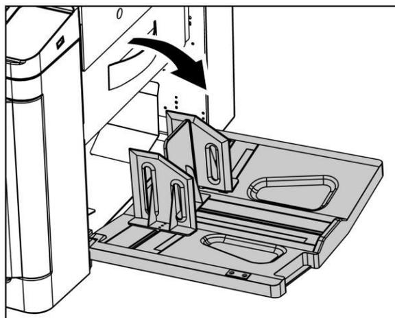
2.) Отрегулируйте направляющие в соответствии с размером бумаги, используемой для печати;
