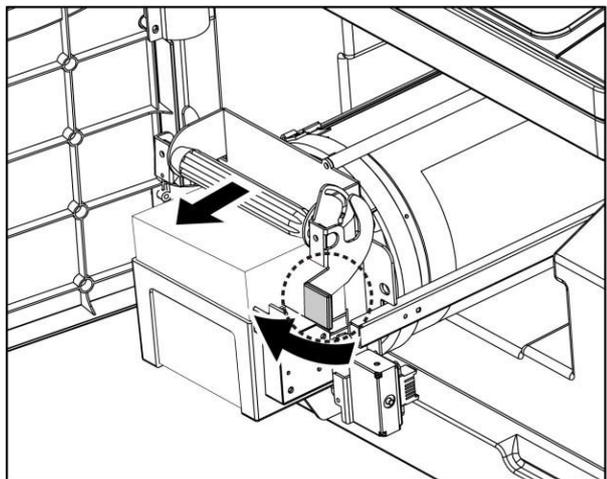
4. Возьмитесь одной рукой за ручку раскатного цилиндра, а другой - за опорный вал, слегка приподнимите раскатный цилиндр, а затем вытащите его;
