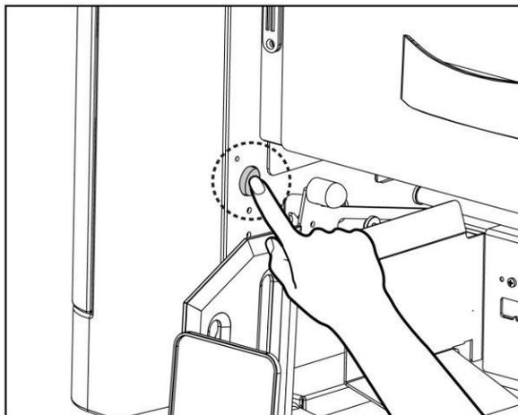
Когда замятая бумага прикреплена к барабану и ее нельзя извлечь автоматически нажатием микропереключателя, вам необходимо извлечь замятую бумагу вручную. Для этого выполните следующие действия:
