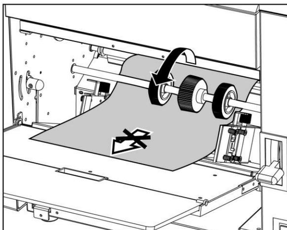
3. Нажмите и удерживайте микропереключатель барабана, до тех пор пока барабан перестанет вращаться и Вы не услышите кратковременный звуковой сигнал.
