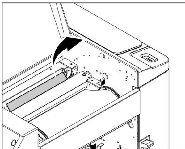
3. Закройте крышку блока изготовления мастер-плёнки;
