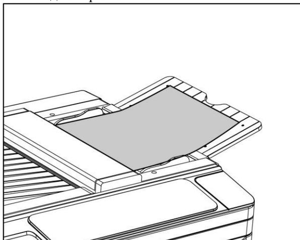
2. Нажмите клавиши 【 ◀】 или 【 ▶】 [Printing speed adjustment] на панели управления, оригинал протянется сканером или вернется назад. Световой индикатор при этом не изменит своего положения.
