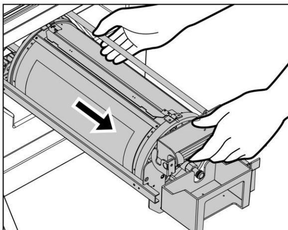
5. Поднимите стопор раскатного цилиндра и найдите край замятого листа;
